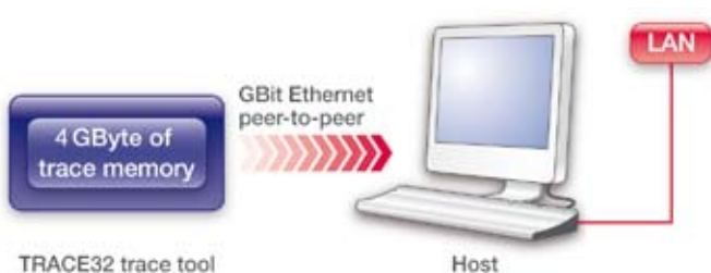
図6: 長時間トレースではホストと高速なP2Pインタフェースが必要
