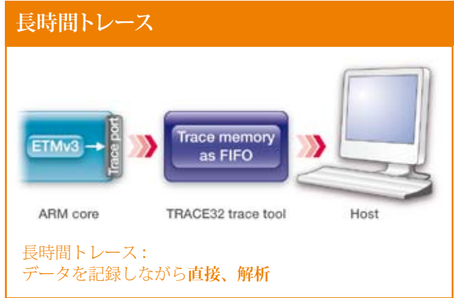
図4: 平行 ETMv3 対応のトレースツールはトレースパッケージ用 16 ピン構成で 8.8 GBit/s のデータ速度をサポート
