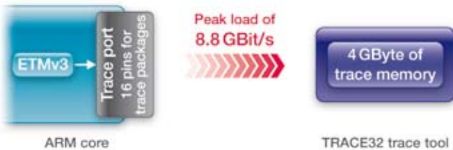
図4: 平行 ETMv3 対応のトレースツールはトレースパッケージ用 16 ピン構成で 8.8 GBit/s のデータ速度をサポート
