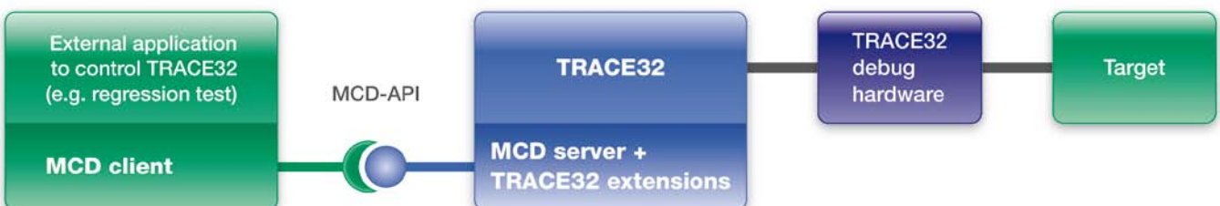
Fig. 17: TRACE32 peut être contrôlé par une application extérieure en utilisant la Remote API.
