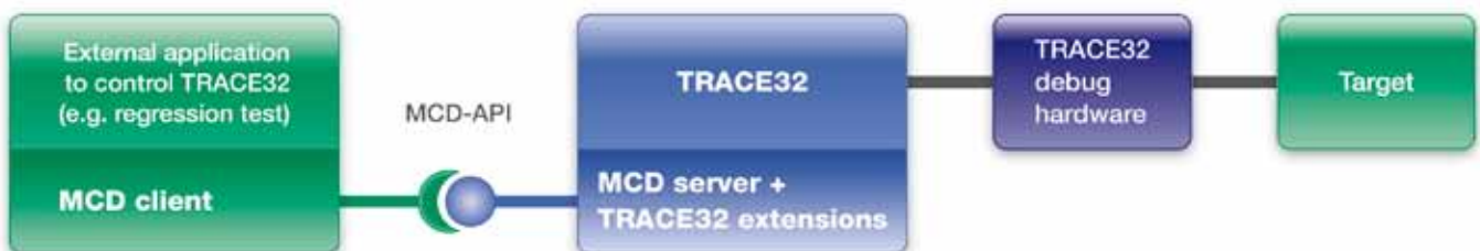
図18: リモートAPIを介してTRACE32を外部アプリケーションで制御可能。
