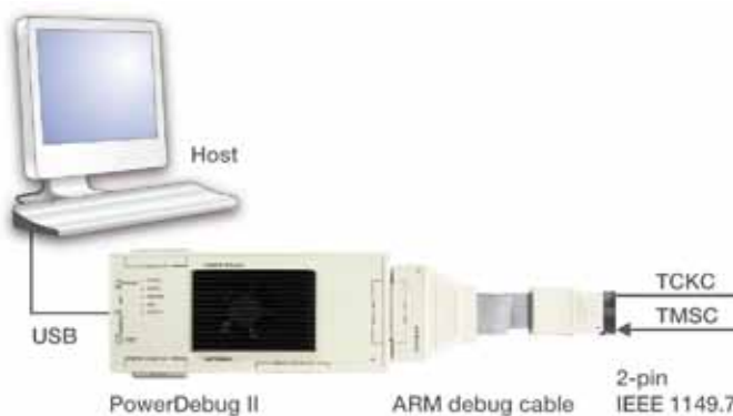
図16: IEEE 1149.7プロトコルは、チップ上で標準のJTAGプロトコルに再変換
