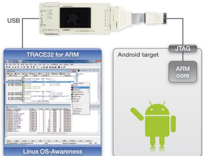
Bild 5: Beim Stop-Mode Debugging kommuniziert der Debugger direkt mit dem Prozessor auf der Android-Hardware-Plattform.
