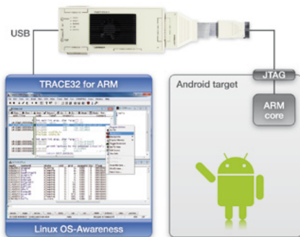
図4: 停止モードデバッグでは、デバッガはAndroidハードウェアプラットフォームのプロセッサと直接通信する
