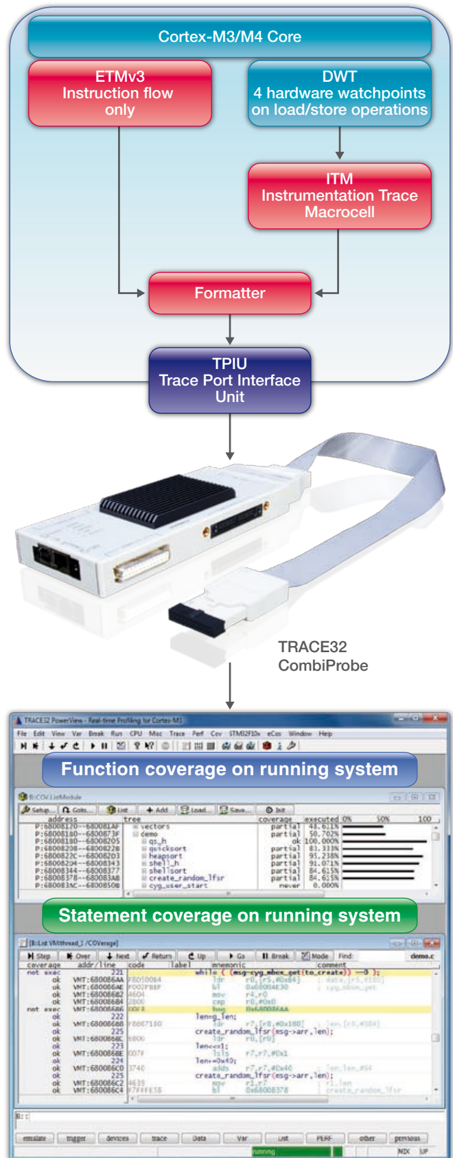
Fig. 17: Il real-time profiling permette di seguire in tempo reale sul monitor l'analisi di code-coverage.
